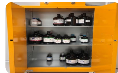
실험실 내 위험물 보관함 설치
